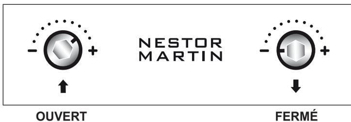
Le clapet avant est ouvert, amenant l'air par en dessous de la grille pour brûler du charbon. Le clapet arrière est fermé.
