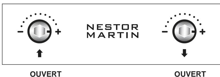
Les deux clapets sont ouverts pour amener une quantité maximale d'air par dessus et par dessous la grille pour faciliter l'allumage.
