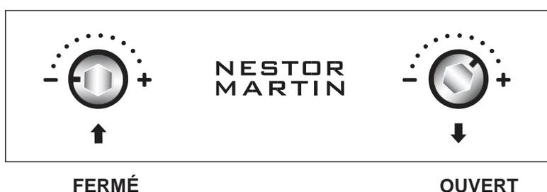
Le clapet arrière est ouvert, amenant l'air par au dessus de la grille. En faisant le tour du corps de chauffe, l'air est réchauffé avant d'arriver au feu, ce qui permet une combustion propre et efficace. L'entrée d'air inférieure fermée.
