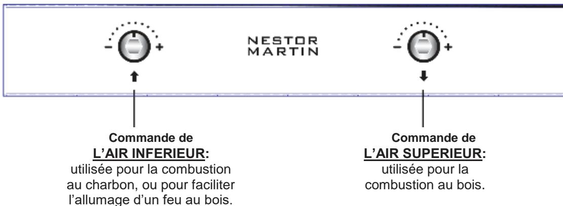
Les commandes actionnent des clapets qui peuvent s'ouvrir et fermer de plusieurs manières, apportant l'air sur le feu de façon à optimiser la combustion en fonction du combustible et de l'intensité désirée.
